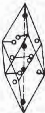
图 1.5 刚玉结构的 \text{M}_2\text{O}_3 型氧化物晶胞图 ○—氧离子，●—金属离子
